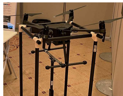
360°カメラを搭載したドローン
