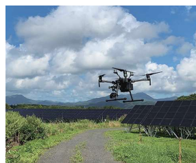
ソーラー発電のパネル点検
