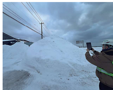
iPad-LiDAR による計測
