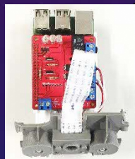
コントローラ（カメラ・マイコンを内蔵した画像認識による融雪制御器）
