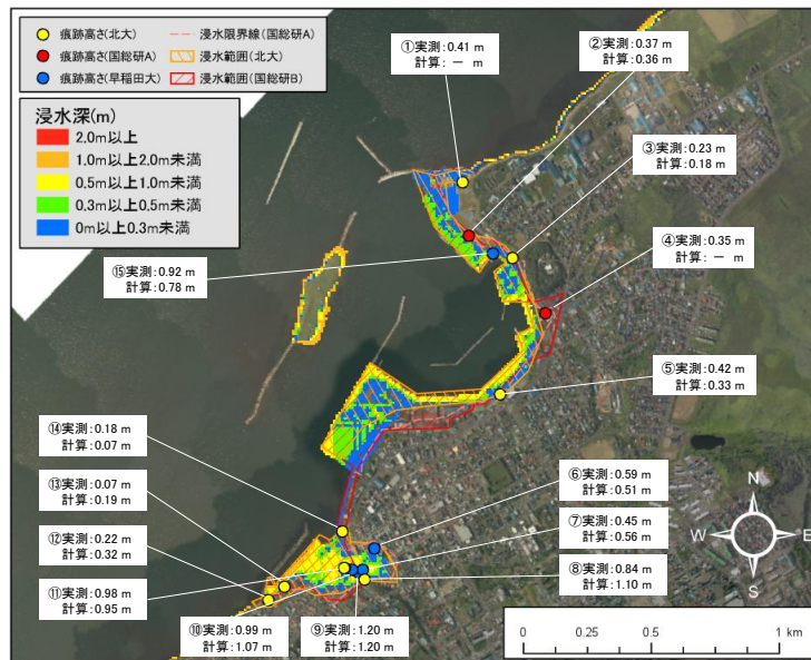
図- 13 2014 年 12 月高潮の実際の浸水状況と計算結果の比較 (上: 浸水範囲、下: 浸水深)
