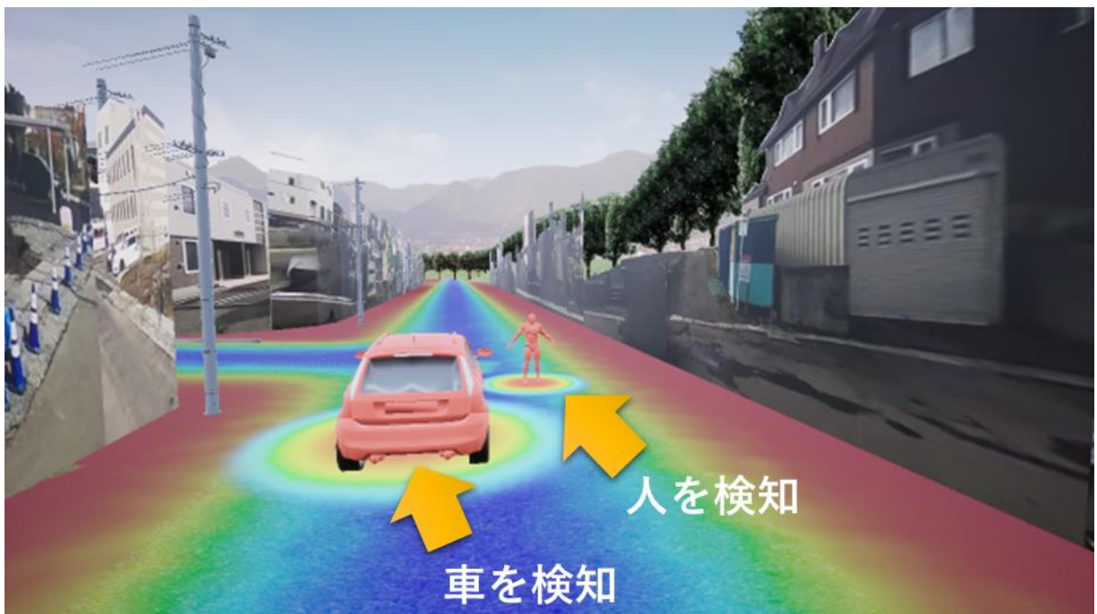
図 2-8 人及び車を動的に認識し表示した状態
