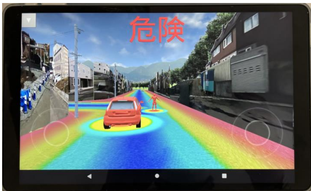
図 2-10 IoT端末にハザードマップ情報を移植した状態
