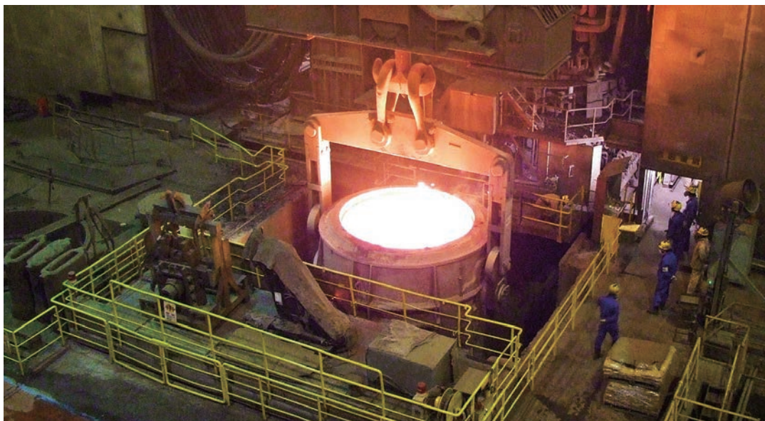
製鋼工場「120トン でんきろ 電気炉」
