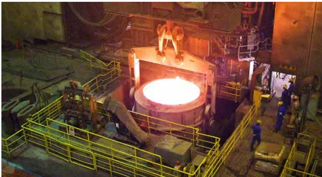
製鋼工場「120トン電気炉」
